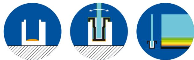
Einfache Montage + Stufenlose Justierbarkeit = Gleichmäßige Glaslagerung ohne Spannungsspitzen
