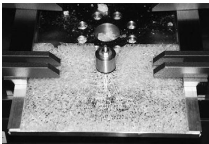
Beispiel Bruchbild Kleinversuch
